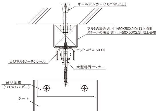
⚠ アンカーボルトは、1Mピッチ以内で固定して下さい。
