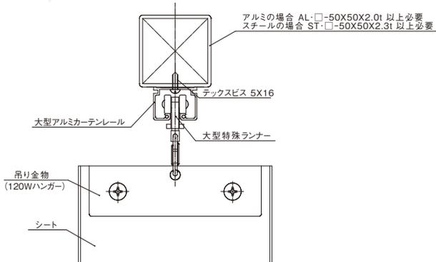
⚠ テックスビスは、端から50m/m立ち上げて約300m/mピッチで固定して下さい。
