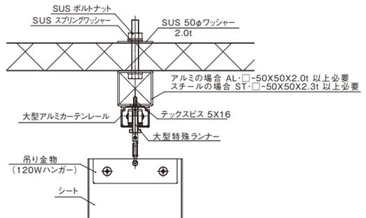
⚠ SUSボルト部材は、1Mピッチ以内で固定して下さい。
