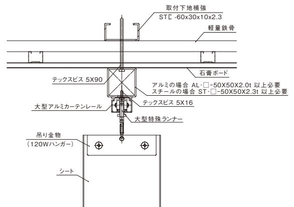
⚠ テックスビスは、端から50m/m立ち上げて約300m/mピッチで固定して下さい。
